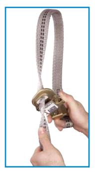
(para aplicaciones de amarre del 100%). Todas las correas para absorción de impacto de WrapBax™2 cuentan con una acción de desgarro única cuando se los somete a fuerzas de detención de caídas. Éstos absorben la energía de manera eficiente, lo que limita la fuerza máxima de detención a menos de 6 kN con espacio libre por debajo de los requisitos de anclaje de 6,75 m.
